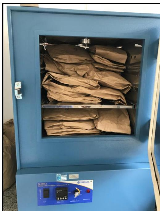
**Figura 8.** Amostras condicionadas no interior da estufa de secagem.
